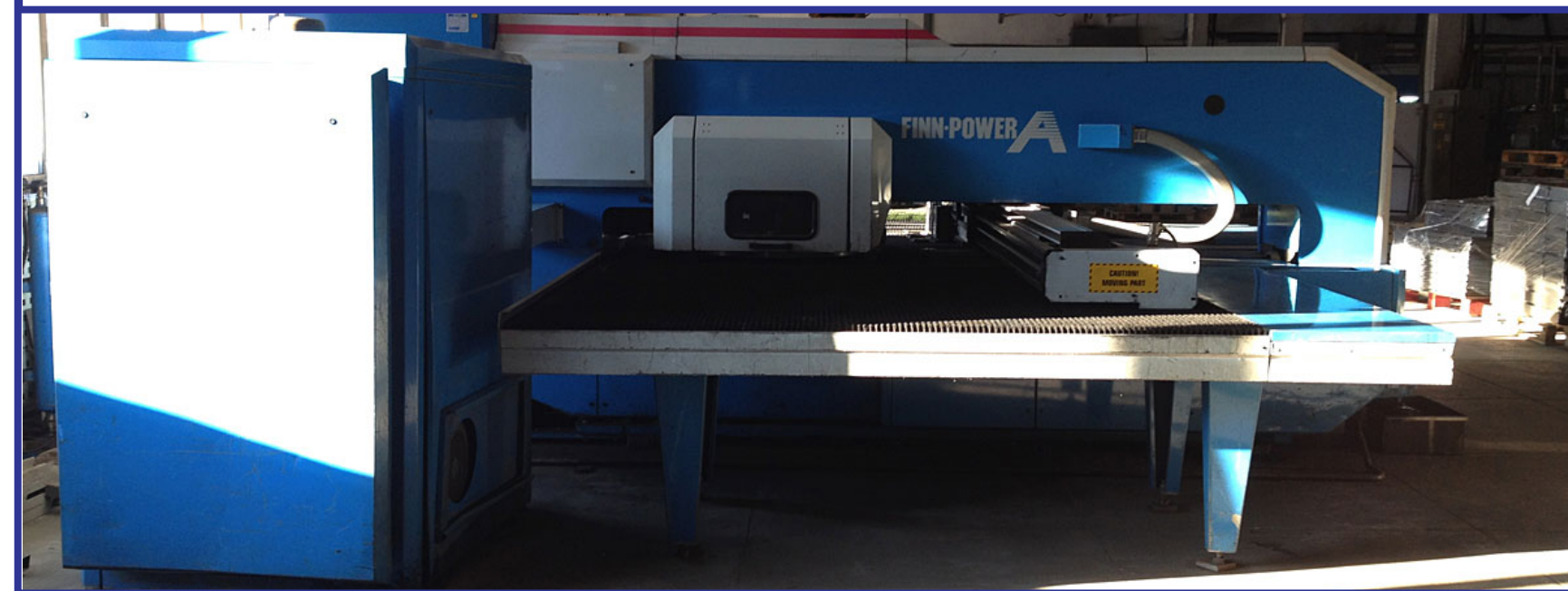
Раскрой металла посредством координатной вырубki
